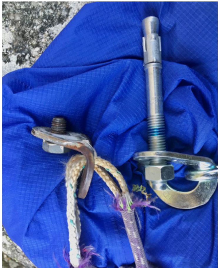
Spit de 10mm esperando ser sustituido por parabolts 12mm .
